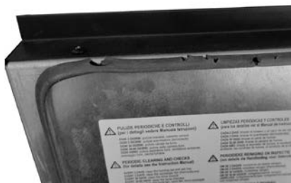
Fig. 21 - Zniszczona uszczelka
